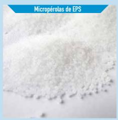
As pérolas de EPS são usadas especialmente na composição de concreto leve e em aplicações com funções não estruturais como: fabricação de blocos vazados, peças pré-cortadas, etc.
