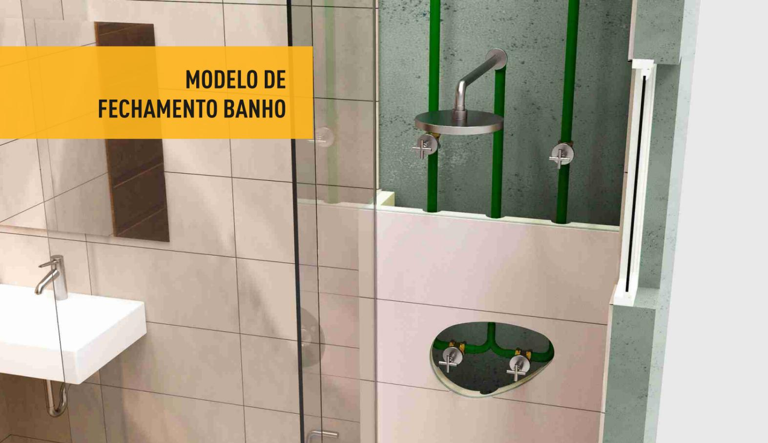
Painel de EPS revestido com argamassa cimentícia flexível, para fechamento de shafts e similares.
